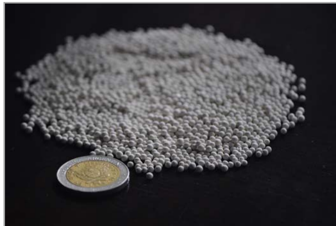
Ilustración 7: Zeolitas utilizadas en el proceso de adsorción por Cambio de Presión PSA
