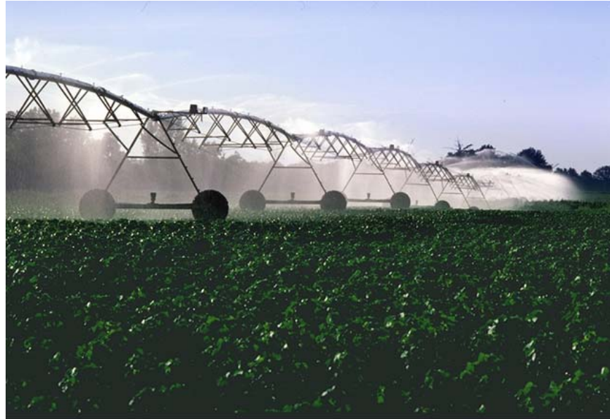
Figura N° 1: Sistema de riego por pivote central (USDA, 2005)
