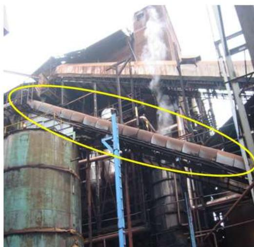
Foto 2a. Sección de Aserrineras: parte baja de la cinta transportadora protegida por una cubierta de chapa.
