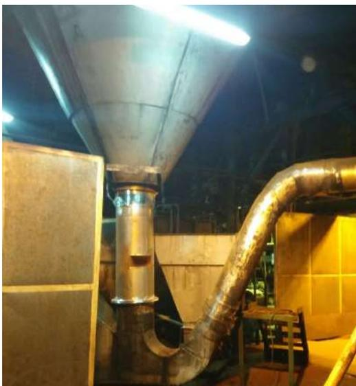
Foto 3a. Sección de secado spray o por atomización.
