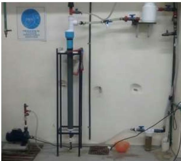
*Figura 8.* Reactor Anaerobio de Lecho Fluidizado a escala piloto.
