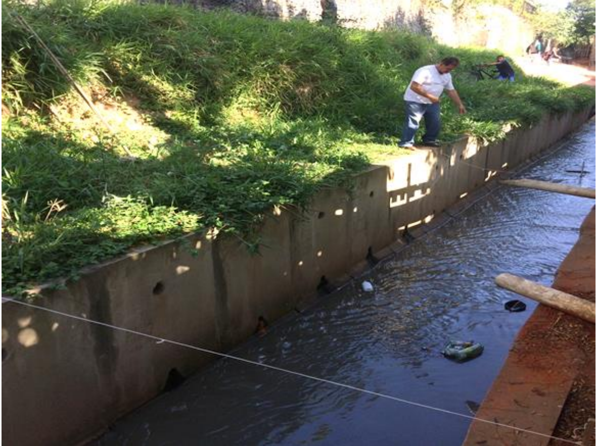
Foto 1: Medición del caudal por el método del flotador. Foto del autor (25 Ago 18).
