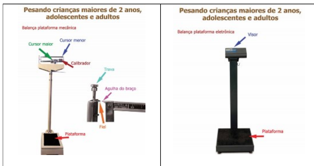
Figura 3: Balanza de Plataforma Mecánica y Eléctrica
