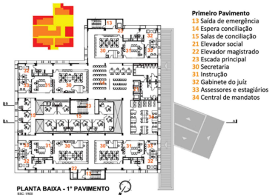
Figura 20. Plano de planta del 1er Pabellón.
