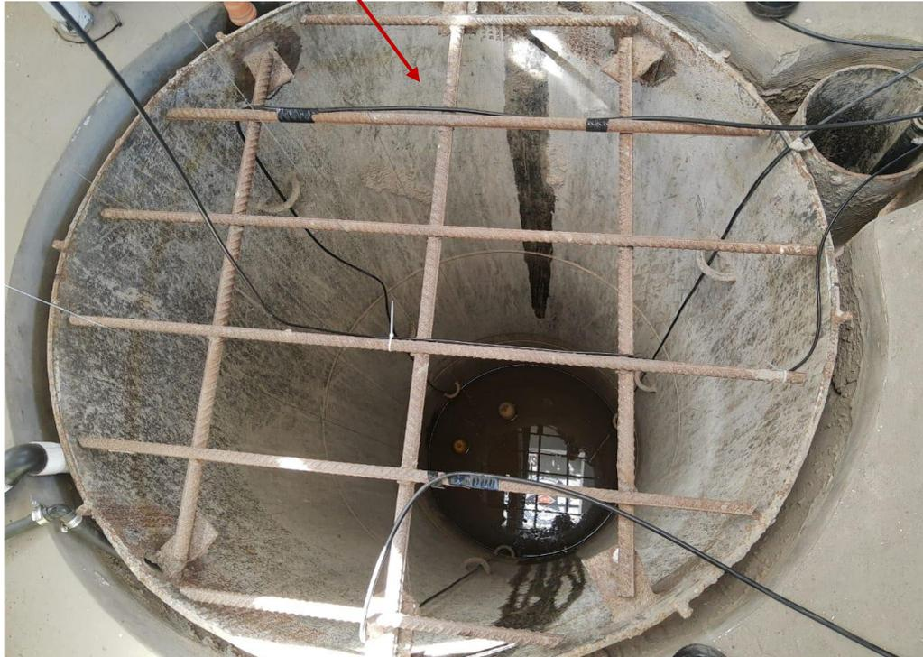
*Figura 13- Casilla sobre el Muelle de Pescadores de la estación mareográfica Palermo (arriba izquierda) donde también se observa el pozo de la estación, sensores digitales Tecmes y Telemark (arriba derecha) emplazados dentro de la casilla y pozo de la estación (abajo), Una flecha roja vincula la vista externa y el interior del pozo de la estación. Cortesía Servicio de Hidrografía Naval, Departamento de Campañas.*
