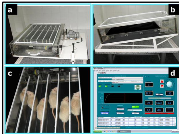
Figura 5. La cinta de correr (“Treadmill-Running”). (a-b) Vista de frente y lateral. (c) seis ratas son entrenadas en la cinta. (d) un software de diseño registra los parámetros de la carrera en tiempo real.
