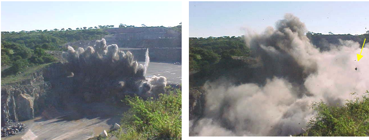
Fotos 7.2 – Foto Izquierda: Explotan 20 tiros de una voladura no controlada, ni dirigida ni con precortes. Foto Derecha: Vista de la onda expansiva y rocas disparadas como proyectiles.
