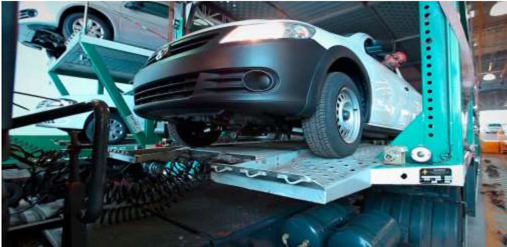
Figura 3 - Proceso de carga de vehículos en el camión cigüeña de forma personalizada.
