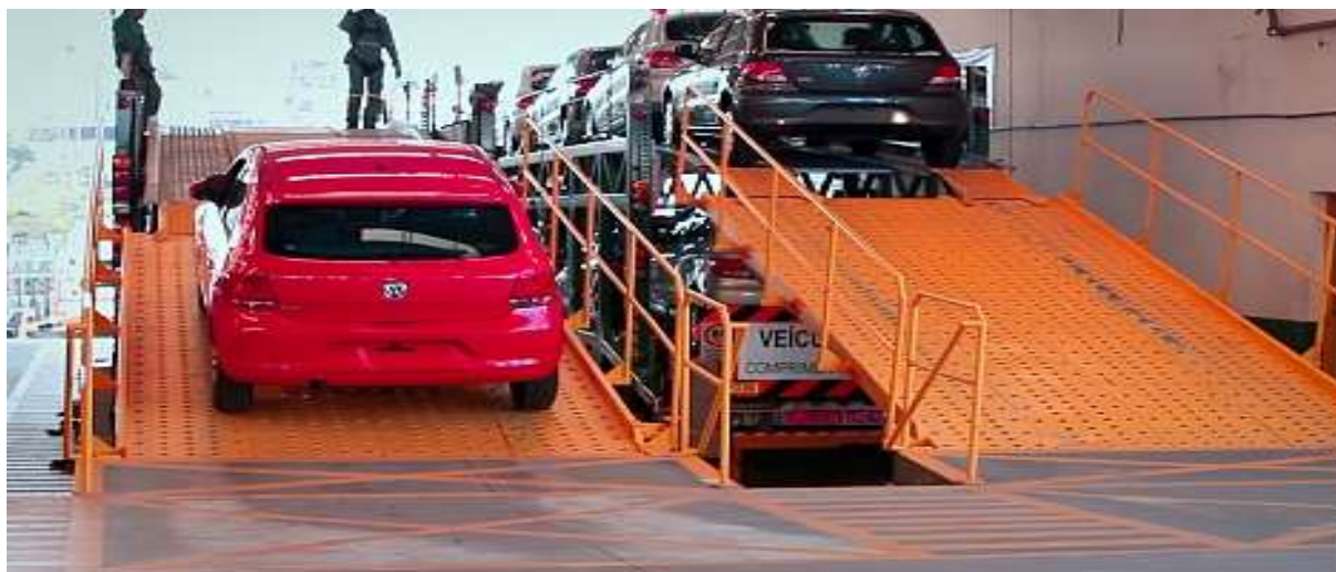
Figura 11 - Porcedimiento de carga de vehículos en el cigüeña.
