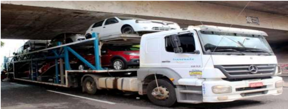
Figura 18 - Peligro en el paso del camión debajo del puente.
